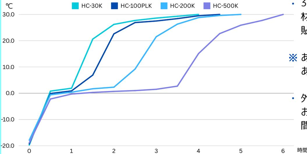
・ 30℃に設定した恒温庫内に保冷材を置き、表面に直接センサーを貼り付け温度測定しました。
